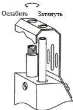
Регулировка силы прижима: сила прижима увеличивается за счет регулирования винтов по часовой стрелке и уменьшения против часовой стрелки, рекомендуется тщательно уменьшать силу прижима без нагрузки на подачу, чтобы уменьшить износ электроприёмника и элементов.
