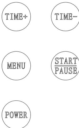
**[POWER «ВКЛ/ВЫКЛ» ]:** После подключения фризера к электросети, аппарат перейдет в режим ожидания и на дисплее появиться «60:00». Нажмите кнопку [POWER], чтобы перейти к выбору настроек. Если Вы нажмете кнопку [POWER] во время работы фризера, то он выключиться.
