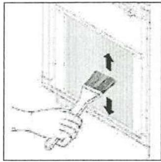
После очистки конденсатора установите защитные панели обратно.
