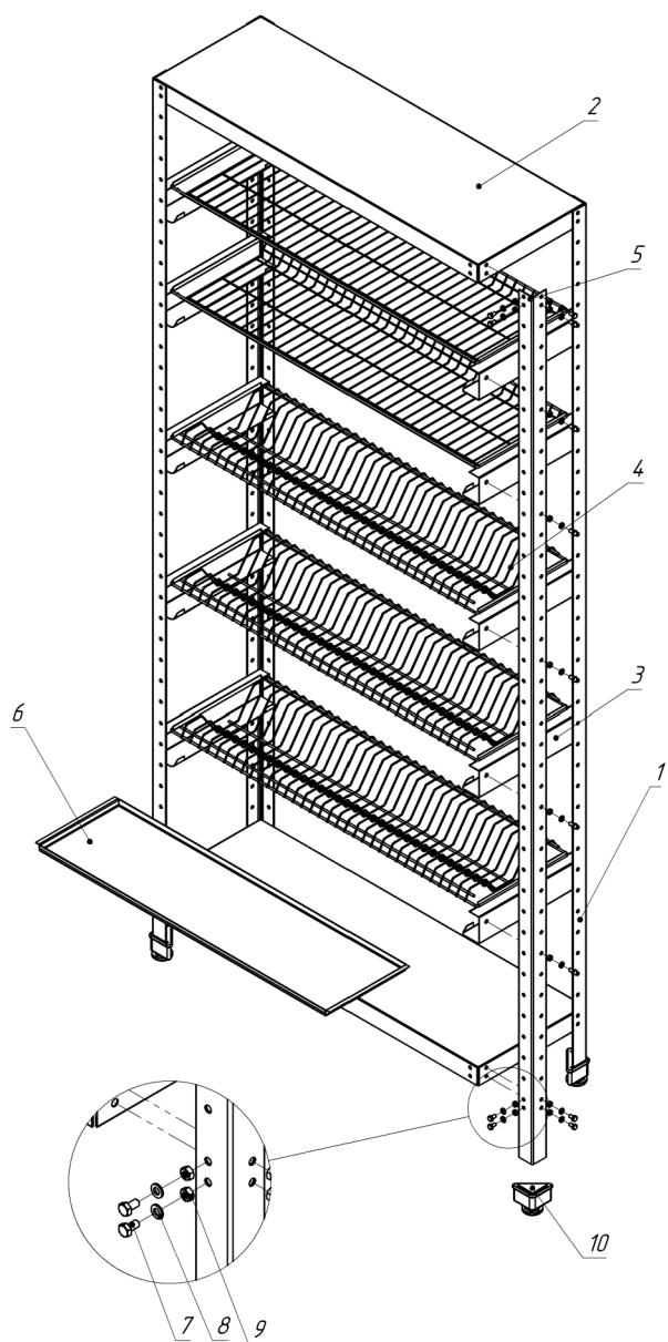
1. Стойки (поз. 1) стеллажа имеют регулировочные опоры (поз. 10), позволяющие придать стеллажу устойчивое положение.
